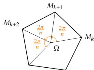
FIGURE 7.2 – Chaque sommet se déduit du précédent par une rotation de centre  $\Omega$  et d'angle  $\frac{2\pi}{n}$ .
